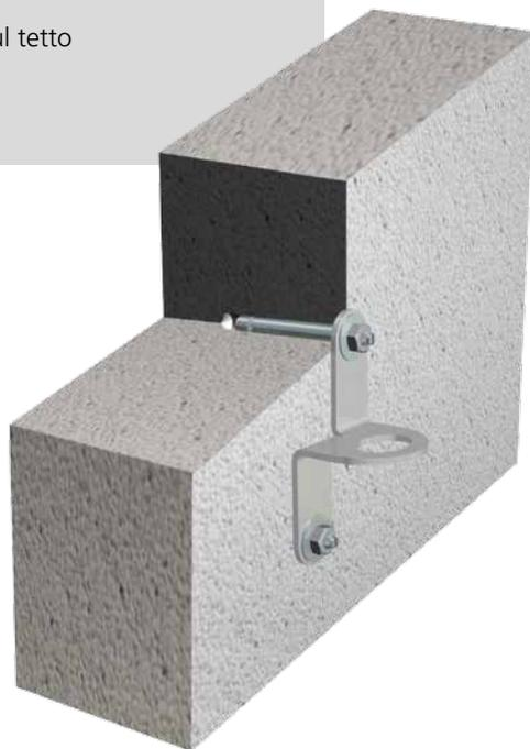
**Descrizione prodotto:** punto di ancoraggio per un massimo di 2 persone. Dispositivo di ancoraggio certificato secondo la normativa UNI EN 795. Può essere impiegato come dispositivo singolo (classe A) e come componente di dispositivi di ancoraggio flessibili orizzontali – linea vita (classe C). Interamente realizzato in acciaio inox AISI 304 (V2A).
